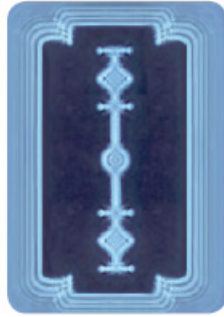
Resim 3.12 Jiletin etrafında ışığın kırınımı
