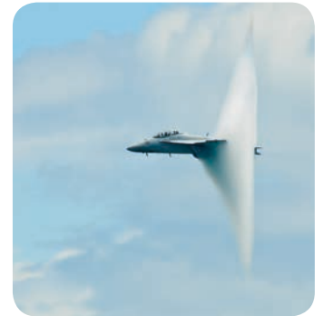
Resim 3.21 Ses duvarını aşan uçakta sonik patlama
